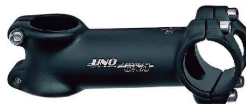
R2123 C0012P86AS007N..... 23,40 € POTENCIA AHEAD UNO ALUMINIO 1.1/8" x 90 mm. x 12°. Negra (manillar Ø 31,8 mm.)
