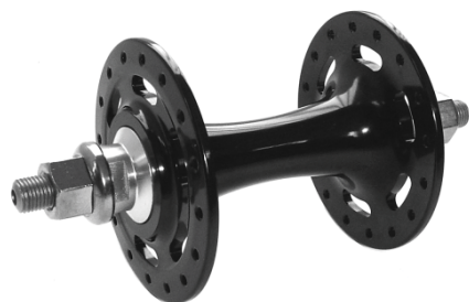
R3118 C0013P00A3633BH..... 24,00 € BUJE PISTA DELANTERO, ALUMINIO 32H. CON TUERCAS Y COJINETES. Negro PCD-L= 62 mm., PDC-R= 62 mm. WL= 14 mm., WR= 14 mm. OLD= 100 mm.
