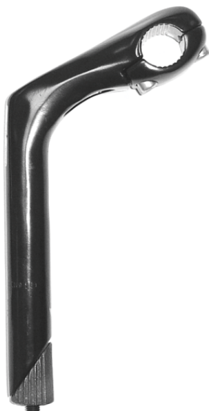
R1966 C0008P46HSC3995..... 15,40 € POTENCIA ALUMINIO NEGRA Ø 25,4 x 80 mm. CAÑA 180 mm. (manillar Ø 25,4 mm.)
