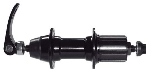
R0002 C0013P34MC833Q28..... 24,20 € BUJE TRASERO CASSET 8/9V. ALUMINIO, 28H. CIERRE RÁPIDO. Negro PCD-L= 45,5 mm., PDC-R= 45,5 mm. WL= 31 mm., WR= 46 mm. OLD= 135 mm.
