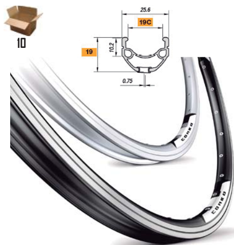
R0355C0010P42M21455.....19,00 € LLANTA 26" MACH1 COMBO (559 x 19C) ALUMINIO, 32H. ERD 537 mm. Plata
