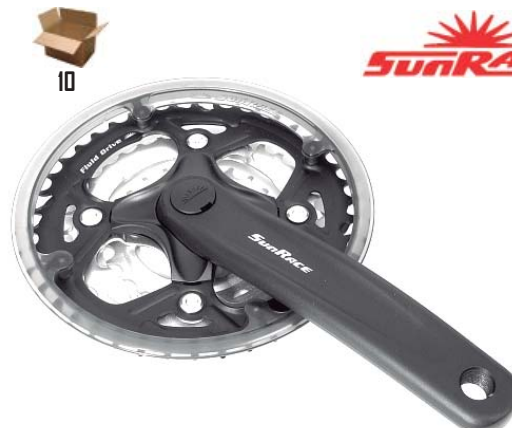
R0376C0012P82FCM520MDD.....23,30 € JG. TRIPLE PLATOS SUNRACE M50 8/7V. 42-34-24T. x 170 mm. (eje 122 mm.) ALUMINIO CON PROTECTOR, 920 gr.
