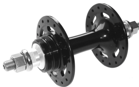
R3119 C0016P00A3735BH..... 29,00 € BUJE PISTA TRASERO, ALUMINIO 32H. CON TUERCAS Y COJINETES. Negro PCD-L= 62 mm., PDC-R= 62 mm. WL= 25 mm., WR= 25 mm. OLD= 120 mm.
