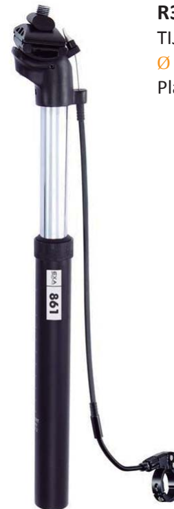
R4505 C0063P36KSP8..... 115,00 € TIJA SILLÍN REMOTE AJUSTABLE SUSPENSIÓN RECORRIDO 3 cm. Ø 27,2 x 100 x 365 mm. 708 gr.
